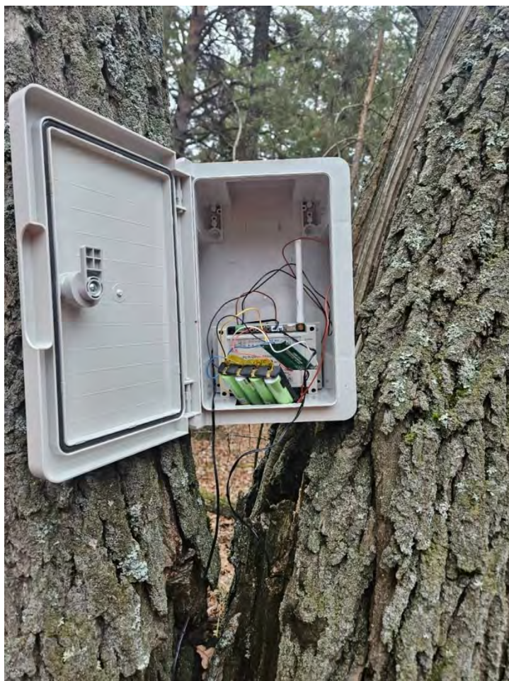
Рис.11. Полевые тесты почвенных термометров в лесном массиве Старомайнского района Ульяновской области
