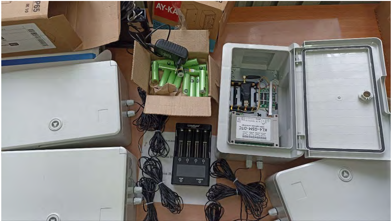
Рис. 9. Почвенные термометры в защитных коробах. Можно увидеть, что от каждого короба отходят по два сальника с проводами термодатчиков. Каждый термометр имеет по два термодатчика
