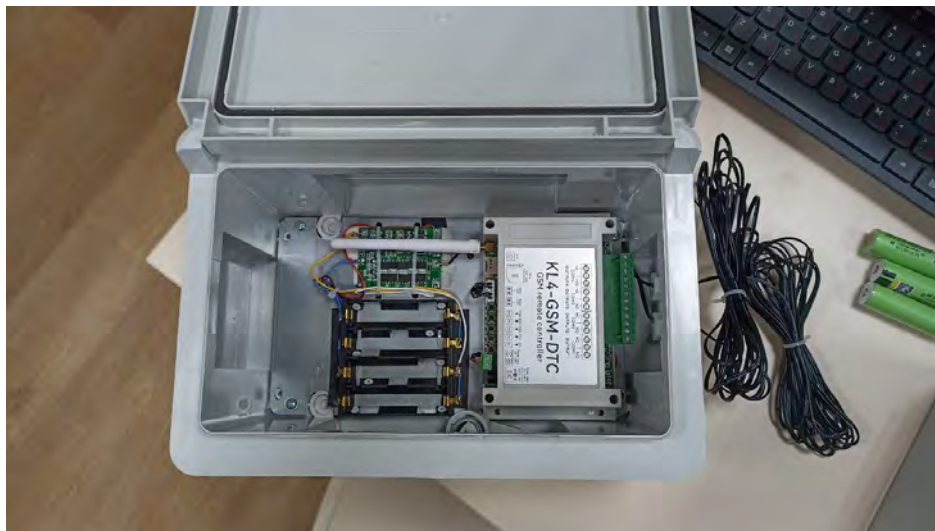
Рисунок 13 . Общий вид почвенного термометра в защитном корпусе на презентации проекта
